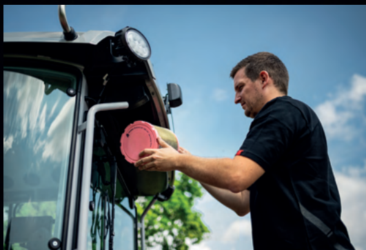
Enkel åtkomst till hyttens luftfilter för rengöring.
