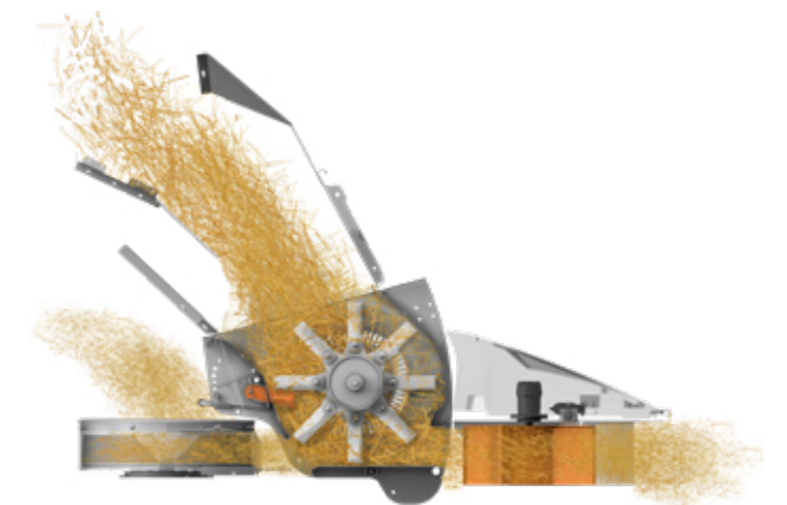
▲ Halmhacken ShortCut – kraftfull spridning och lätt att justera
