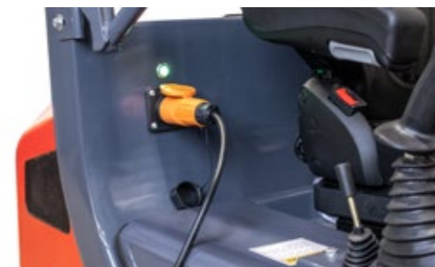
Integrerad 230V-laddare som standard med en laddningstid på 6–8 timmar.
