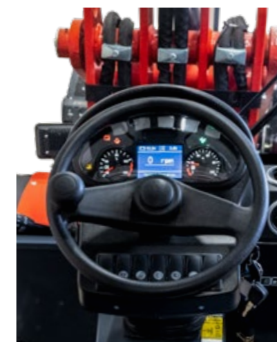
Överskådliga instrument med ergonomiskt lättmanövrerad joystick för lastaren med inbyggd fram- och backreglering. Hastigheten är steglöst justerbar via fotpedal med inch-funktion.
