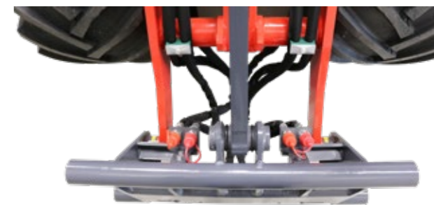
Redskapsfäste med Trima/SMS samt hydrauliskt redskapslås av redskapet är standard. 3:e funktion är standard, 4:e finns som tillval.
