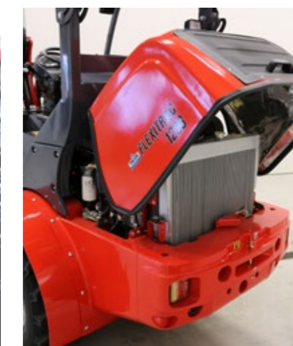
Bra åtkomst för underhåll och service med öppningsbar huv, bältade sidokåpor samt fällbar stol. Väl tilltaget kylpaket för både hydraulik och motor.
