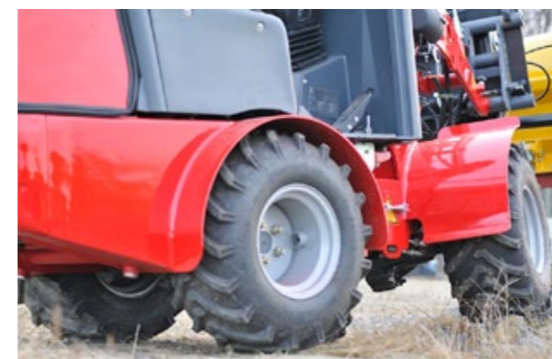
En ledad midja ger fler däck i grepp i kuperad terräng. Trejon Flexitrac kompaklastare är utrustade med rejäla däck. Vid behov finns fler alternativ.
