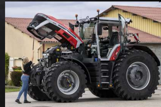
Framaxelns och motorhuvens insvängda midjedesign gör det enkelt att komma åt oljemätstickan och filtret
