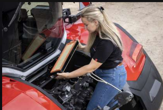
Enkel åtkomst till hyttens luftfilter för rengöring
